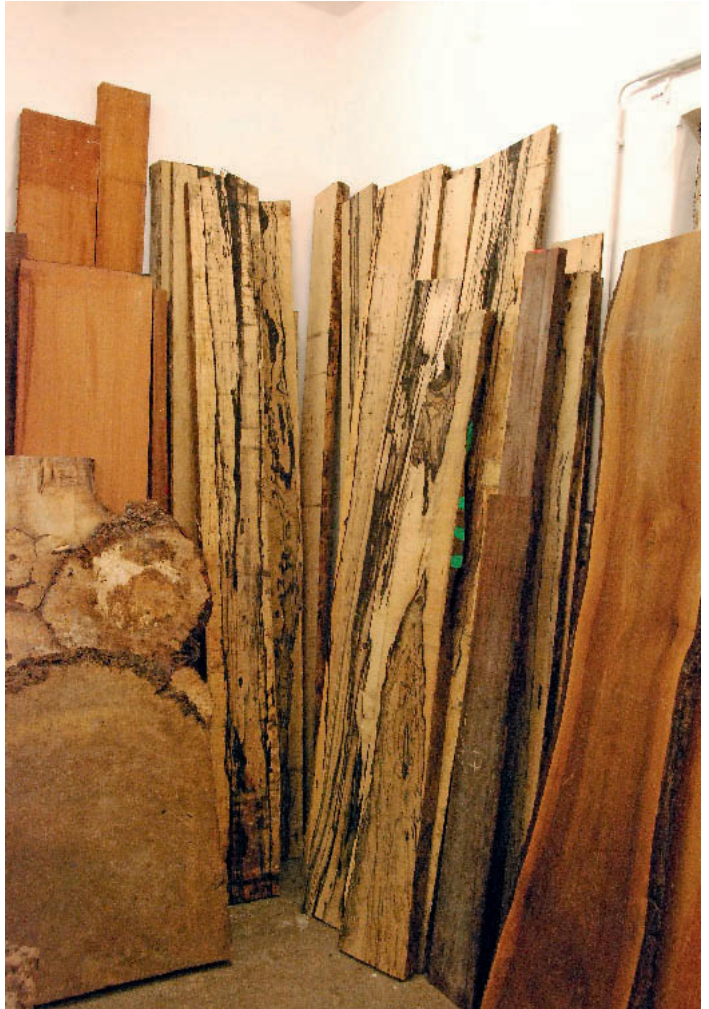
/ Bretter, Bohlen und Maserholzscheiben unterschiedlichster Hölzer lagern zur schonenden Trocknung im ehemaligen Kühlraum der Pferdemetzgerei.
